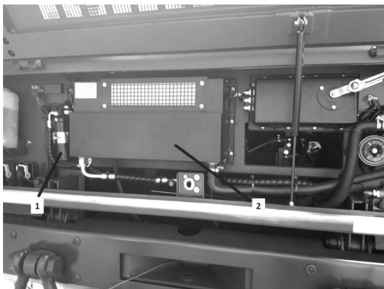
Rys. 2. Widok na zintegrowany moduł klimatyzacji po podniesieniu maskownicy. 1 – osuszacz, 2 – zintegrowany zespół klimatyzacji
