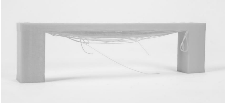
Rys. 5. Uszkodzony druk z powodu zbyt dużej odległości elementów podporowych (suport) [8]
