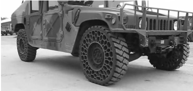
Rys. 1. Pojazd HMMWV z kołami kompozytowymi [2]
