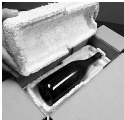
Rys. 7. Przykład wypełnienia z grzybni Fig. 7. example of mycelium filling
