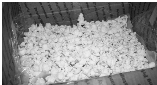
Rys. 6 . Przykład wypełnienia kukurydzianego w formie ziaren po obróbce termicznej Fig. 6. Example of corn filling in the form of grains after heat treatment
