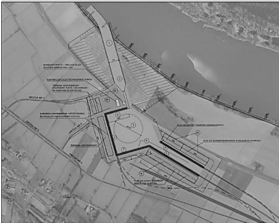
Rys. 8. Projekt zagospodarowania terenu pod platformę logistyczną – wariant 2 [13]
