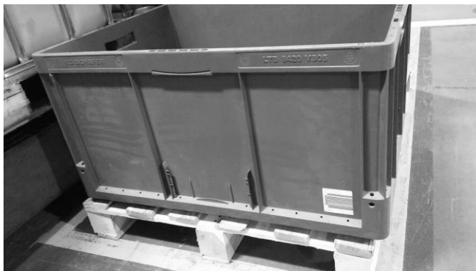
Rys. 5. Opakowanie w postaci pojemnika z własnym kodem kreskowym Fig. 5. Packaging as a container with its own bar code
