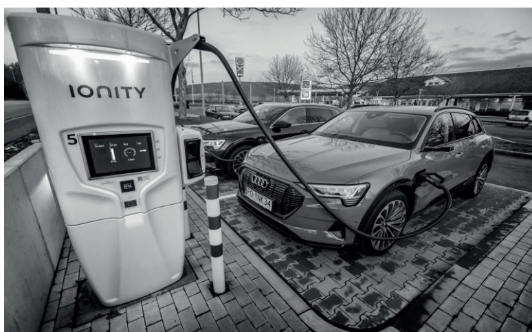
Rys. 3. Ładowanie samochodu osobowego metodą plug-in [15].
