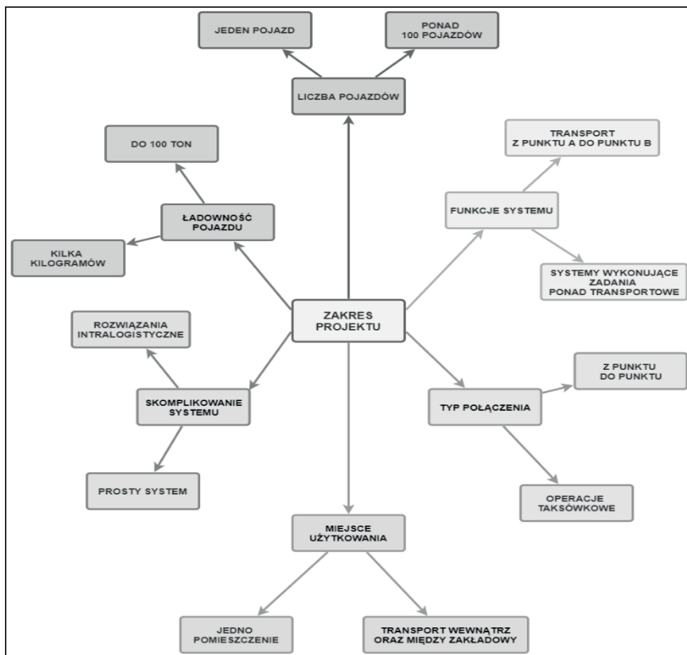
Rys. 3. Zakres projektu wdrożenia systemu AGV (opracowanie własne na podst. [3]).
