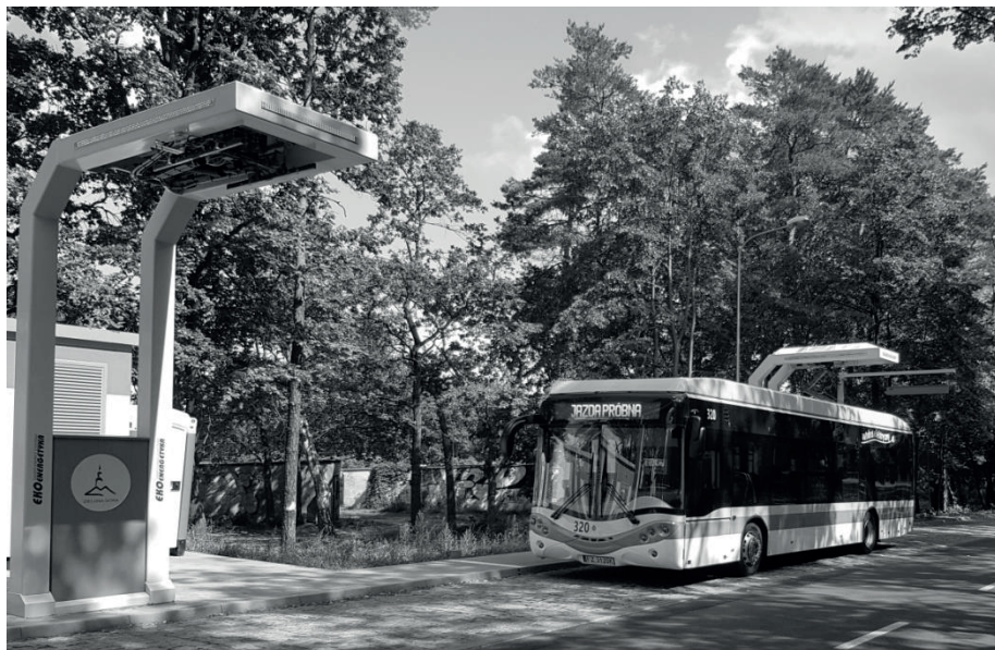
Rys. 1. Autobus URSUS CS12LFE podczas ładowania baterii [3]
