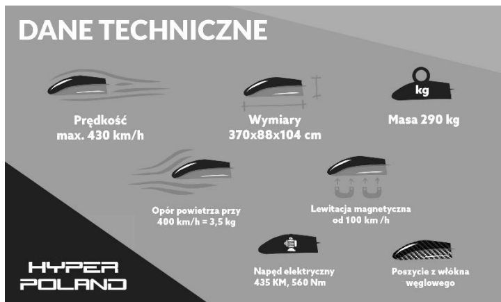
Rys. 3. Dane techniczne kapsuły zaprojektowanej przez Hyper Poland
